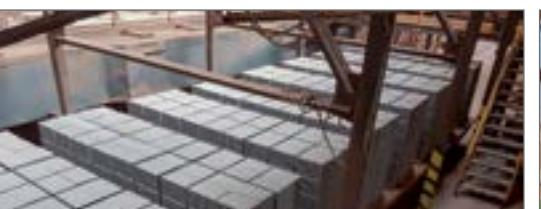
Suché výlisky tehál uložené na pecných vozoch čakajú na vstup do peci, kde sa podrobia skúške ohňom • Dry-pressed bricks loaded onto kiln wagons are waiting to enter the kiln, where they will undergo a fire test
