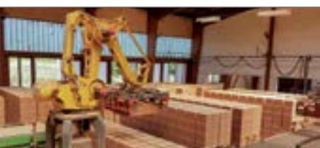
Preklad hotových tehál z pecných vozov, ktoré výšli z pece na dopravníkový pás baliacej linky • When the finished bricks leave the kiln, they are loaded onto the kiln wagons onto the conveyor belt of the packaging line
